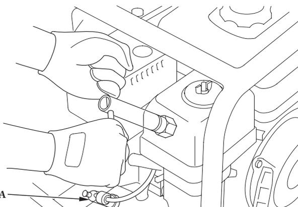
2. Inspeccione visualmente la bujía. Tire la bujía si tienen desgaste aparente o si el aislador está partido o rajado. Limpie la bujía con un cepillo de alambre si se debe volver a utilizar.
