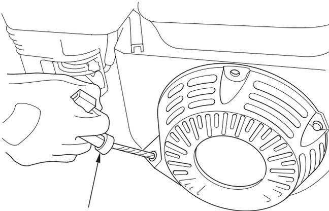
EMPUÑADURA DEL MOTOR DE ARRANQUE
